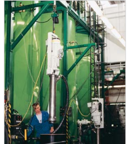
JDN air hoist mini handling a submersible pump.
